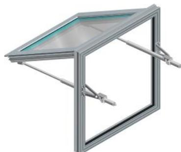
**Fig. 42** Fenêtre d'évacuation de fumée mcr OSO THERM 75 avec deux vérin à tige S et un point de pivot décalé pivot point
