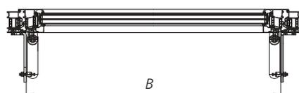
**Fig. 20** Coupe transversale horizontale **B-B** à travers fenêtres d'évacuation de fumée mcr OSO THERM 75 en position fermée
