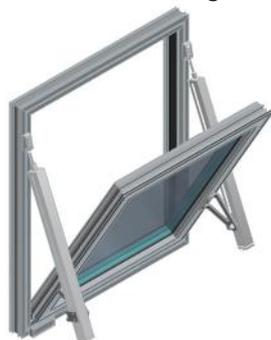
**Fig. 53** Fenêtre d'évacuation de fumée mcr OSO THERM 75 avec deux vérin à tige G et un point de pivot décalé
