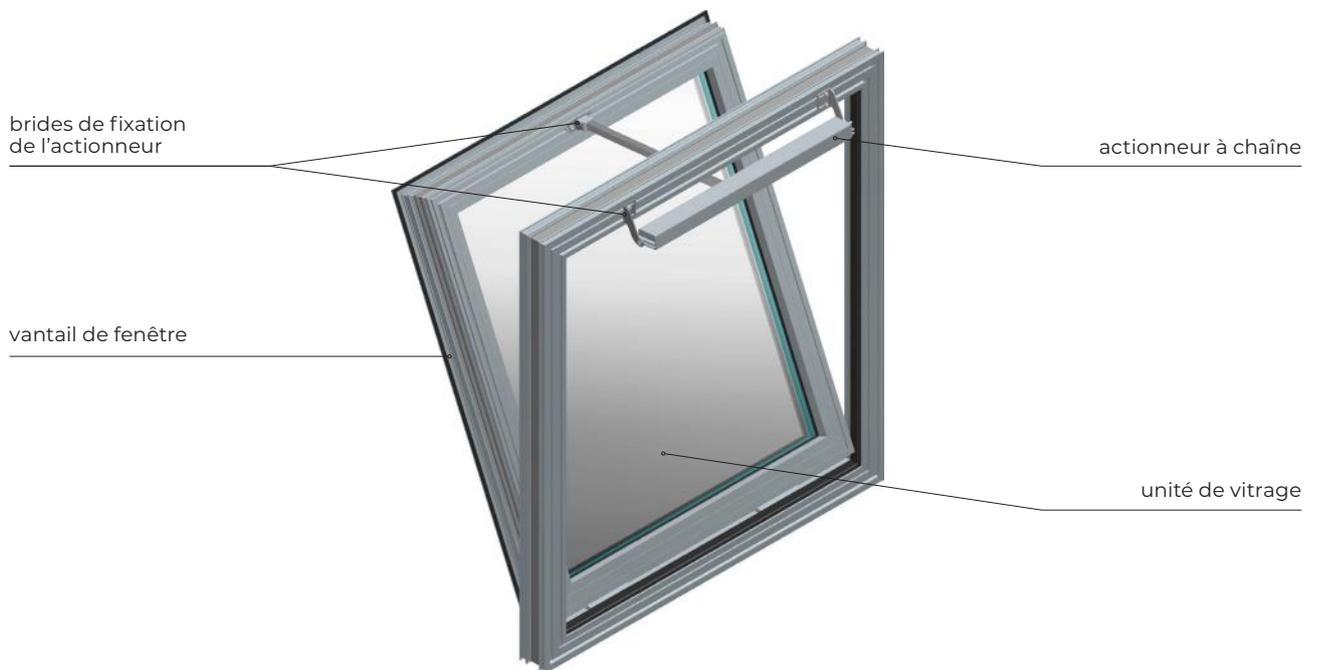
**Fig. 16** Fenêtre d'évacuation de fumée mcr OSO THERM 75 à ouverture vers l'extérieur au moyen d'un vérin à chaîne unique
