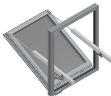
**Fig. 39** Fenêtre d'évacuation de fumée mcr OSO THERM 75 avec deux vérin à tige G et un point de pivot décalé point
